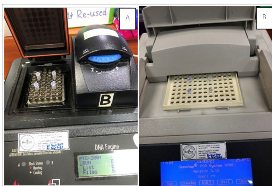
ภาพ 14 รูปแบบการวางหลอดที่เหมาะสมกับเครื่องพีซีอาร์แต่ละแบบ
